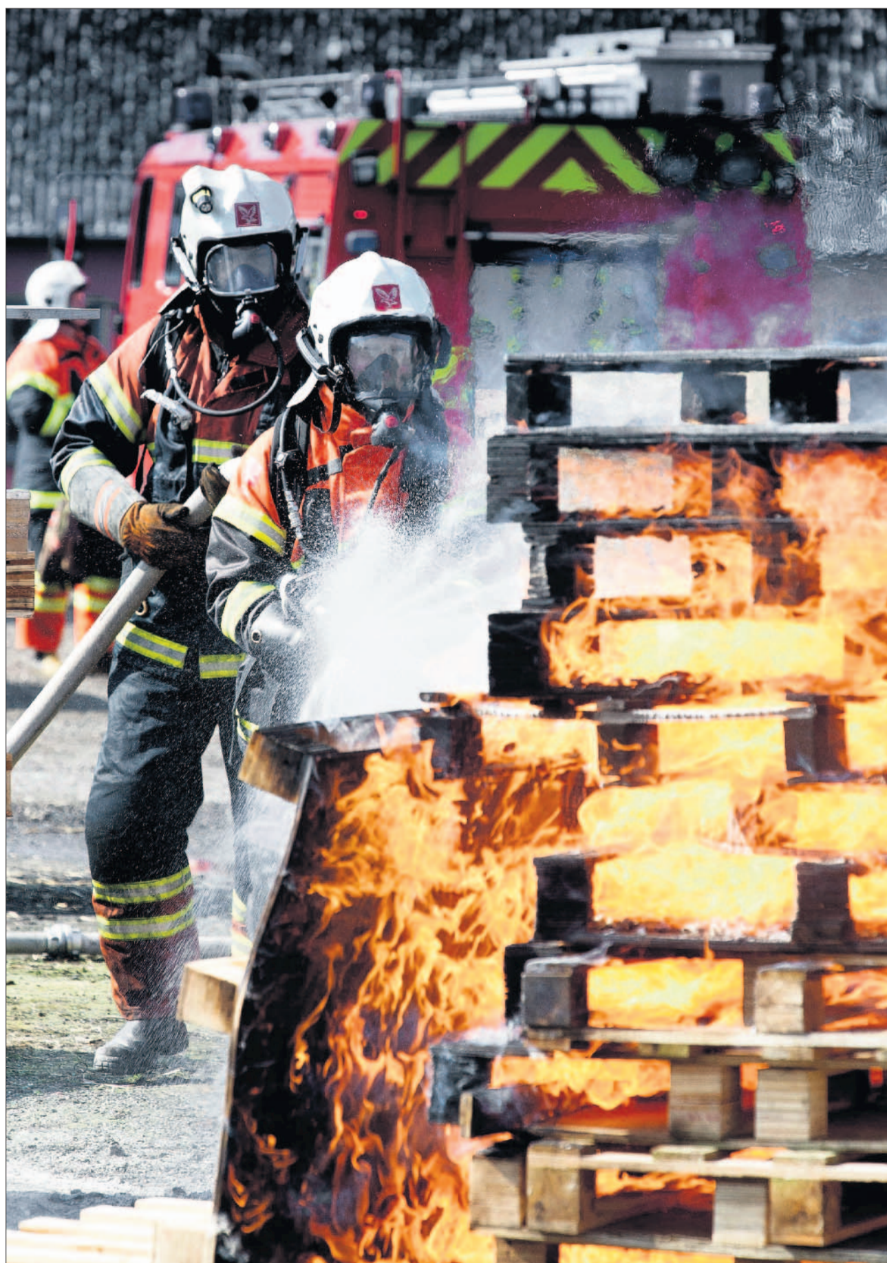
Brandfolkene antændte to bunker af hvert materiale. Den bunke blev slukket med vand, den anden med blandingsproduktet.
